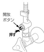
5. 再度カートリッジをキャップに付け直し、水栓に取り付ける。
