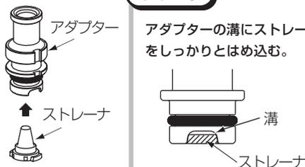
**6** アダプターをバルブに取り付け、ストップリングを取り付け、吐出管に接続する。
